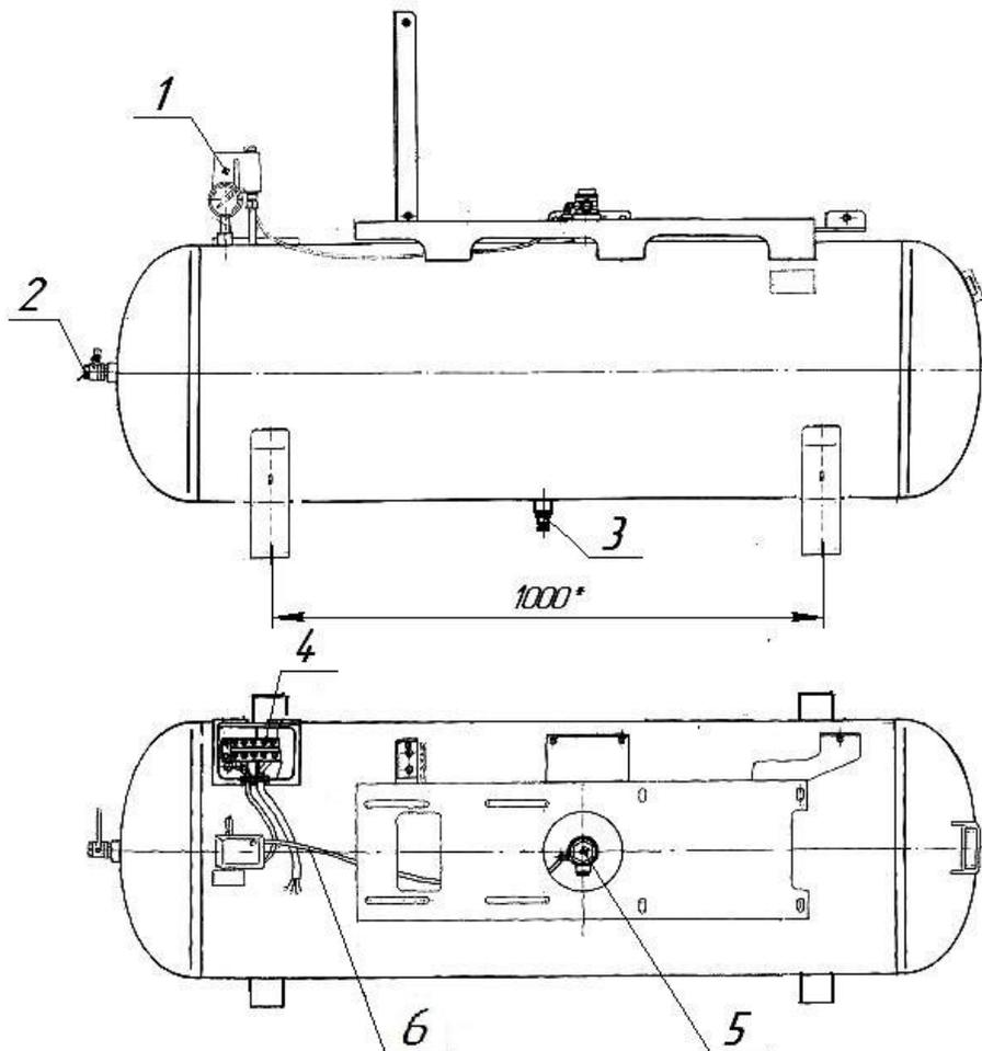
**Рис.10. Ресивер, модель С416М**
