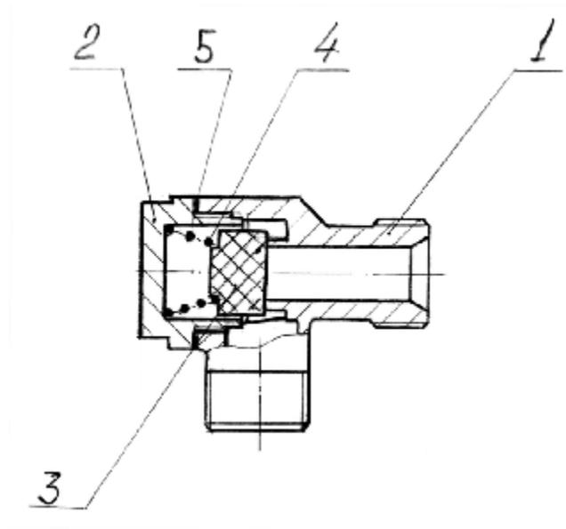
**Рис.13. Клапан обратный**
