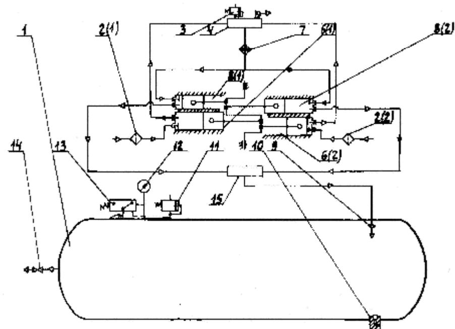
**Рис.15. Схема пневматическая принципиальная компрессора, модель С416М**
