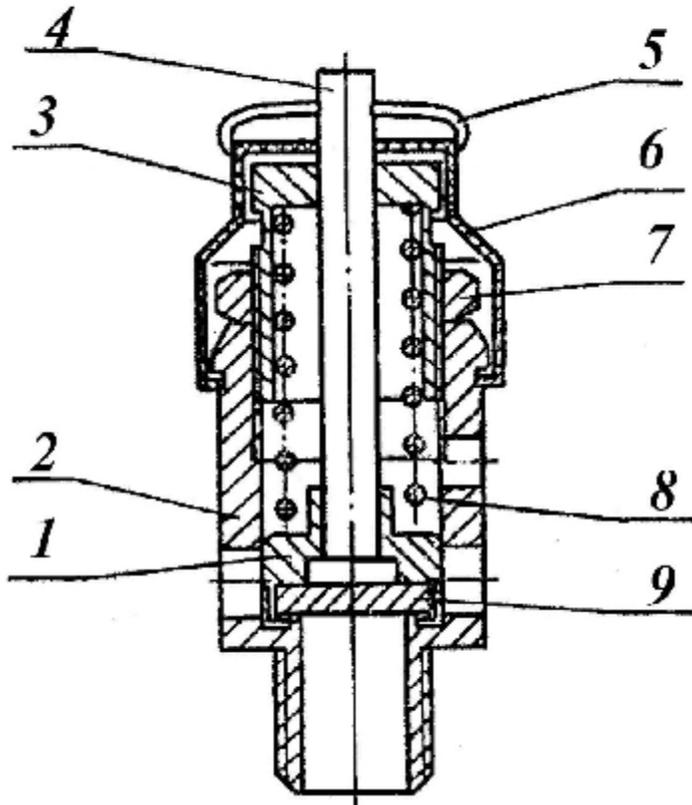
**Рис.12. Клапан предохранительный**
