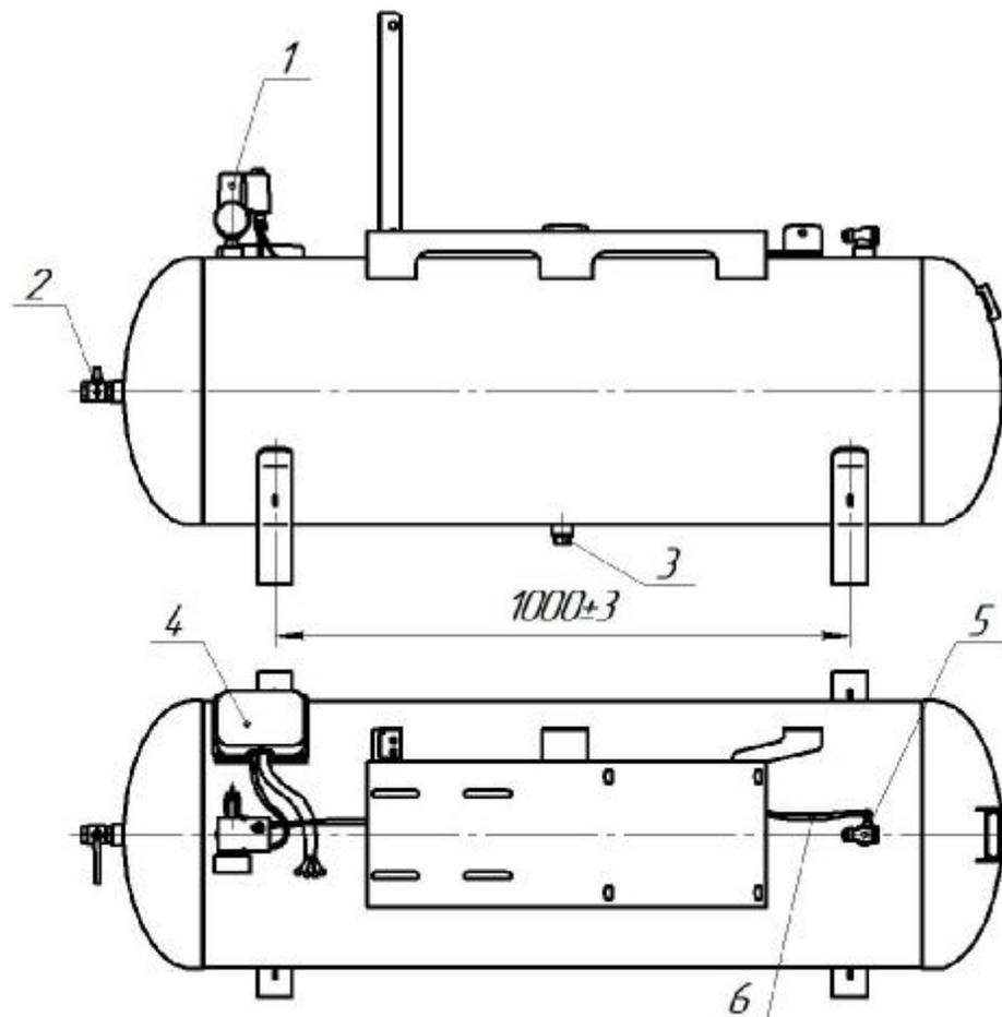
**Рис.9. Ресивер, модель С415М**
